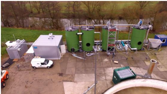
Figura 15. Impianto PtG, elettrolizzatore all'estrema sinistra, sala per la metanazione sulla sinistra e impianto di biogas sulla destra. Foto ©Bernd Krautkremer [117]
