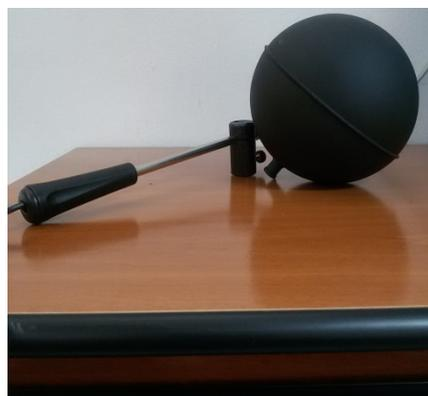
Figura 3.1.4 Sonda globotermometrica.
