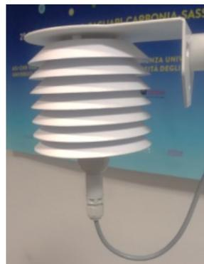
Figura 3.1.3 Sonda termometrica.
