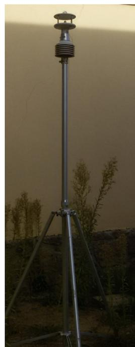
Figura 3.2.2 Sistema di acquisizione variabili termoigrometriche.
