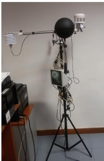
Figura 3.1.1 Centralina microclimatica Grillo MMTS.
