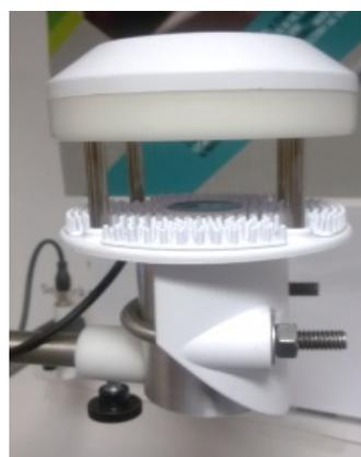
Figura 3.1.5 Sonda anemometrica sonica.
