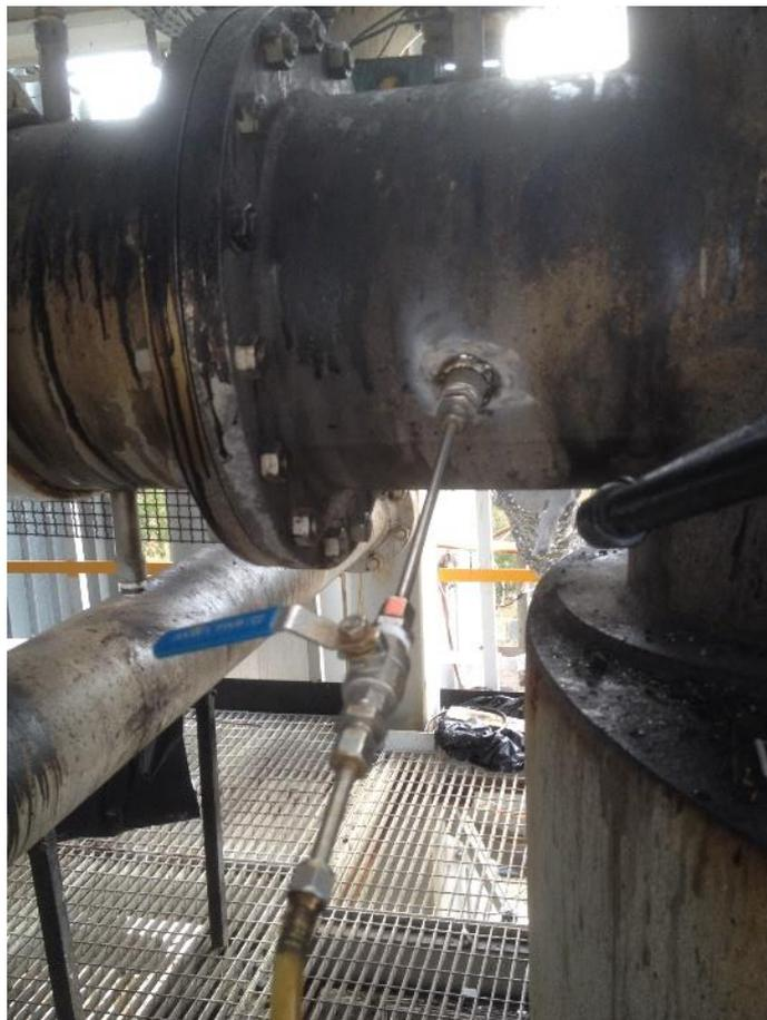
**Figura 25. Punto di campionamento gas in corrispondenza del condotto uscente dalla sommità del gassificatore**
