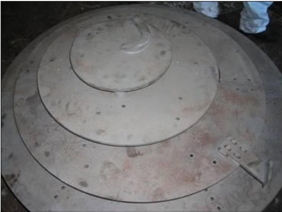
**Figura 2. Parte esterna della griglia del gassificatore dimostrativo.**
