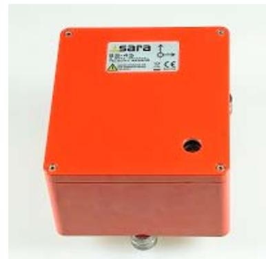
Figura 3.3 – Acquisitore/digitalizzatore 24 bit di tipo Reftek-130\_1 (a sinistra) e velocimetro a medio periodo di tipo Sara SSXX 0.2 Hz (a destra). Le immagini dei due oggetti non sono in scala tra loro.
