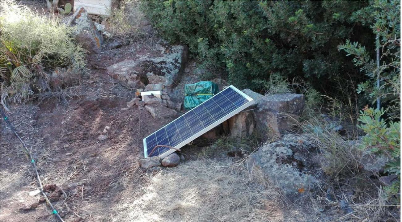
Figura 3.7 – Immagine della stazione sismica SU25
