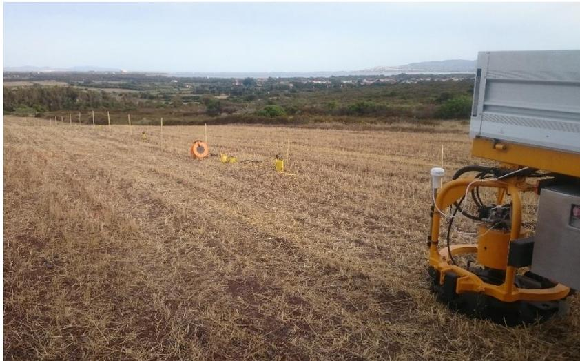
**Figura 2 – Picchettamento e prove vibrometriche lungo la linea HR\_3.**
