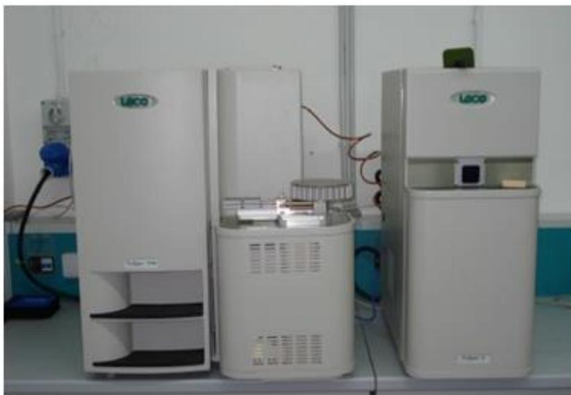
Figura 4. Analizzatore elementare LECO ruspec CHN/S
