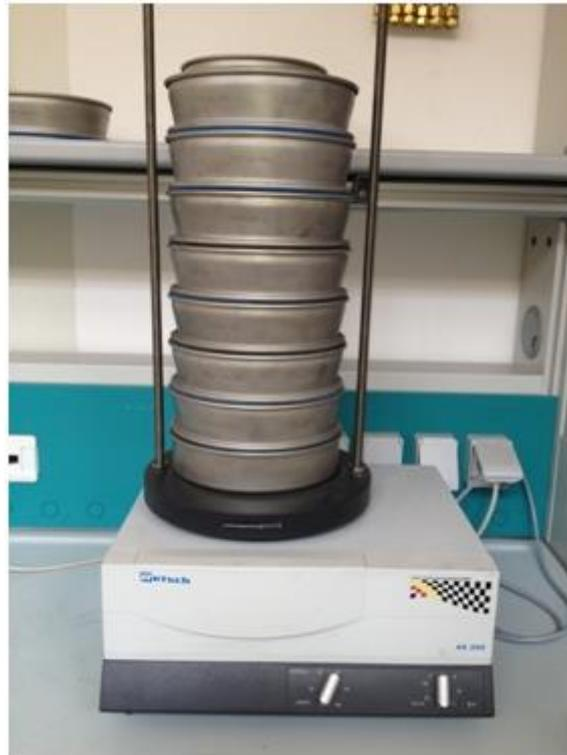
Figura 3. Mulino a vibrazione AS200 Retsch
