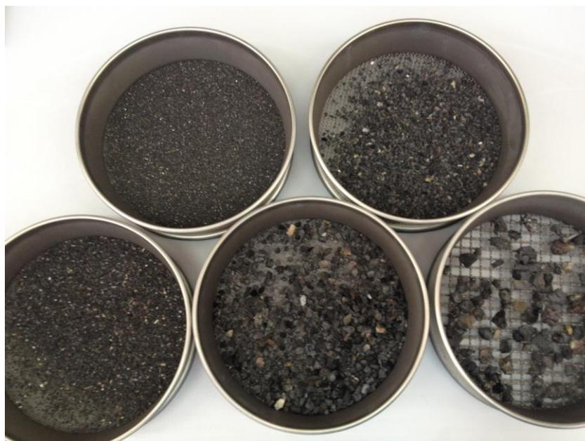
**Figura 8. Separazione granulometrica scarico gassificatore**
