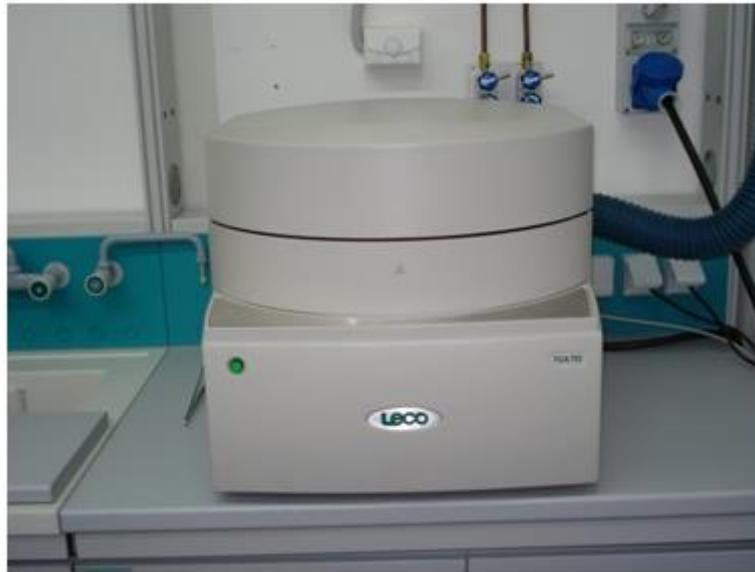
Figura 5. Analizzatore termo gravimetrico LECO TGA-701
