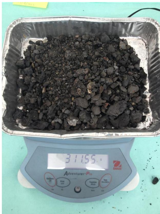
**Figura 7. Pesata di uno scarico del gassificatore**
