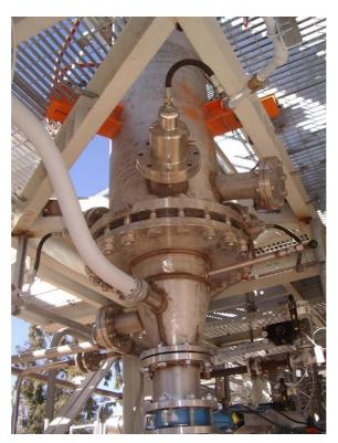
Figura 6.1. La parte inferiore del gassificatore pilota Sotacarbo.
