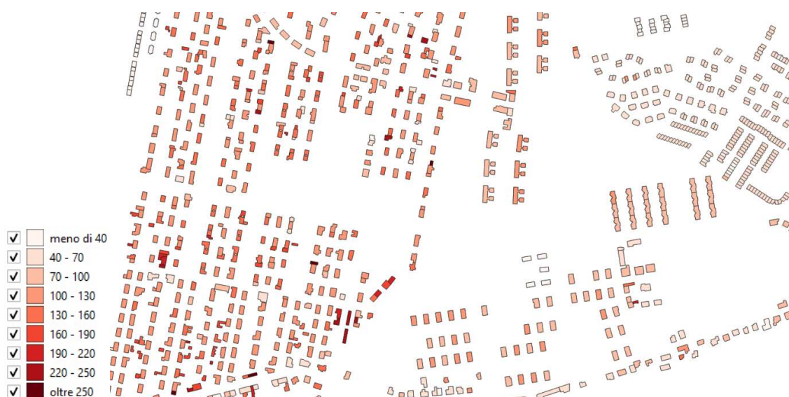
Figura 3.4 – Risultati del calcolo invernale per edificio (kWh/m²).
