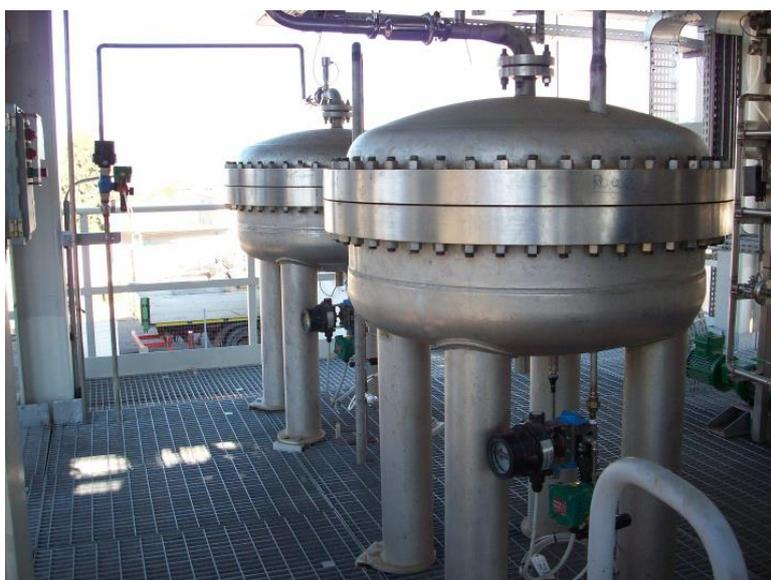
*Figura 2.8. Reattori di assorbimento dell'anidride carbonica.*
