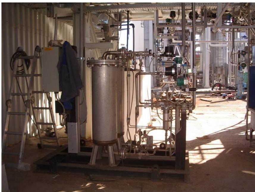
*Figura 2.10. Il sistema PSA per la purificazione dell'idrogeno.*
