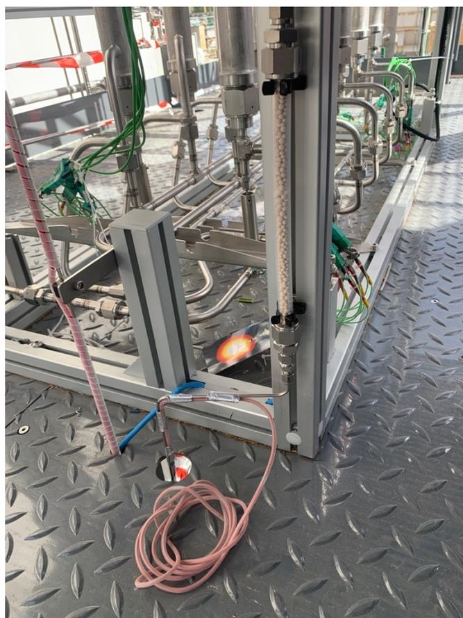
**Figura 3.26. Sonda per il riscaldamento del gas e sistema di protezione umidità (setacci molecolari) posto a monte del GC.**
