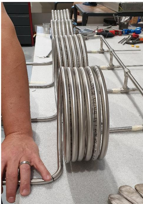
Figura 3.6. Realizzazione degli scambiatori di calore.
