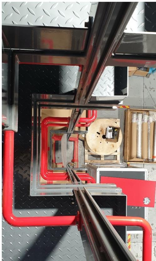
**Figura 3.12. Sede di alloggiamento del reattore a singolo tubo.**
