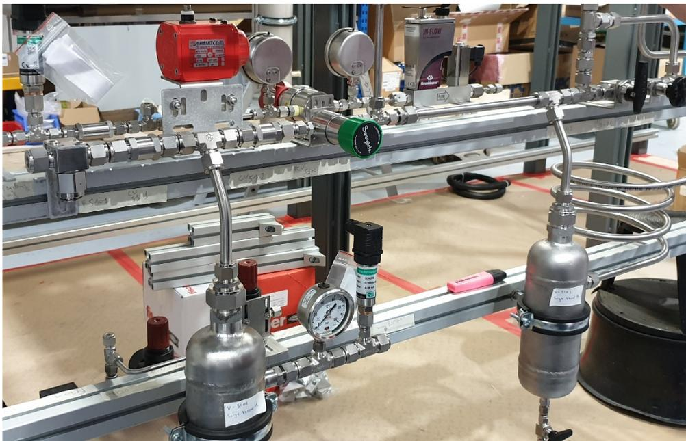
Figura 3.16. Realizzazione della linea di ricircolo gas.
