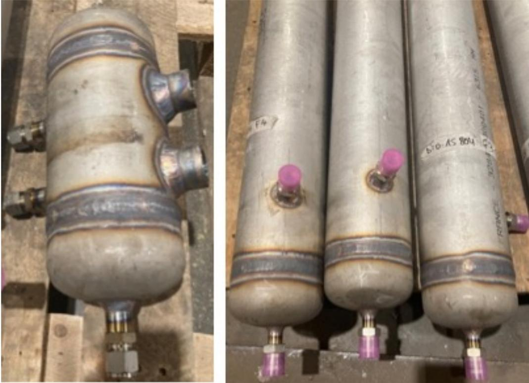
Figura 3.17. Realizzazione della trappola per cere (sinistra) e dei separatori di alta e di bassa pressione e del condensatore (destra).
