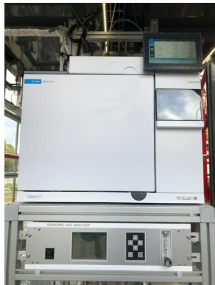
**Figura 3.23. Analizzatore online NDIR (per  $CO$ ,  $CH_4$  e  $CO_2$ ) e TCD (per  $H_2$ ) (a sinistra) e Gascromatografo (a destra).**
