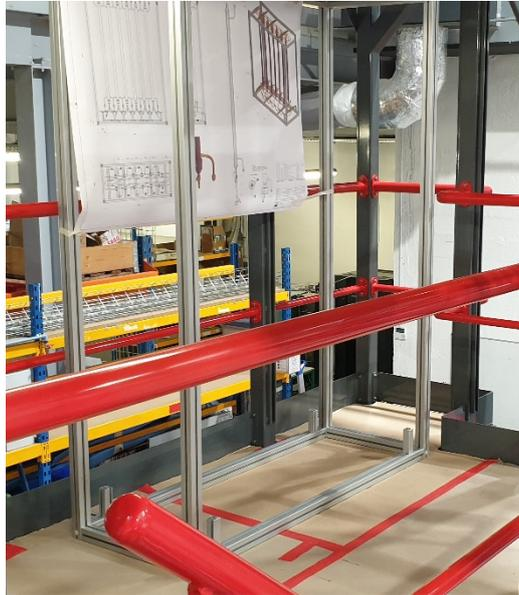
**Figura 3.9. Struttura in profilato di alluminio per l'alloggiamento del reattore multitubolare.**
