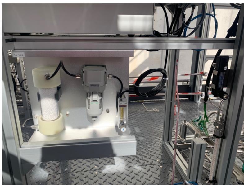
**Figura 3.24. Sistema di pulizia e protezione dell'analizzatore NDIR/TCD.**
