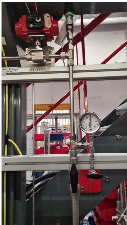
**Figura 3.5. Installazione del gas mixer e particolare dell'uscita e dei suoi componenti.**
