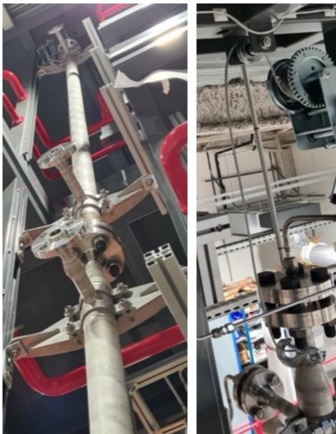
**Figura 3.13. Realizzazione della configurazione reattoristica multitubolare.**
