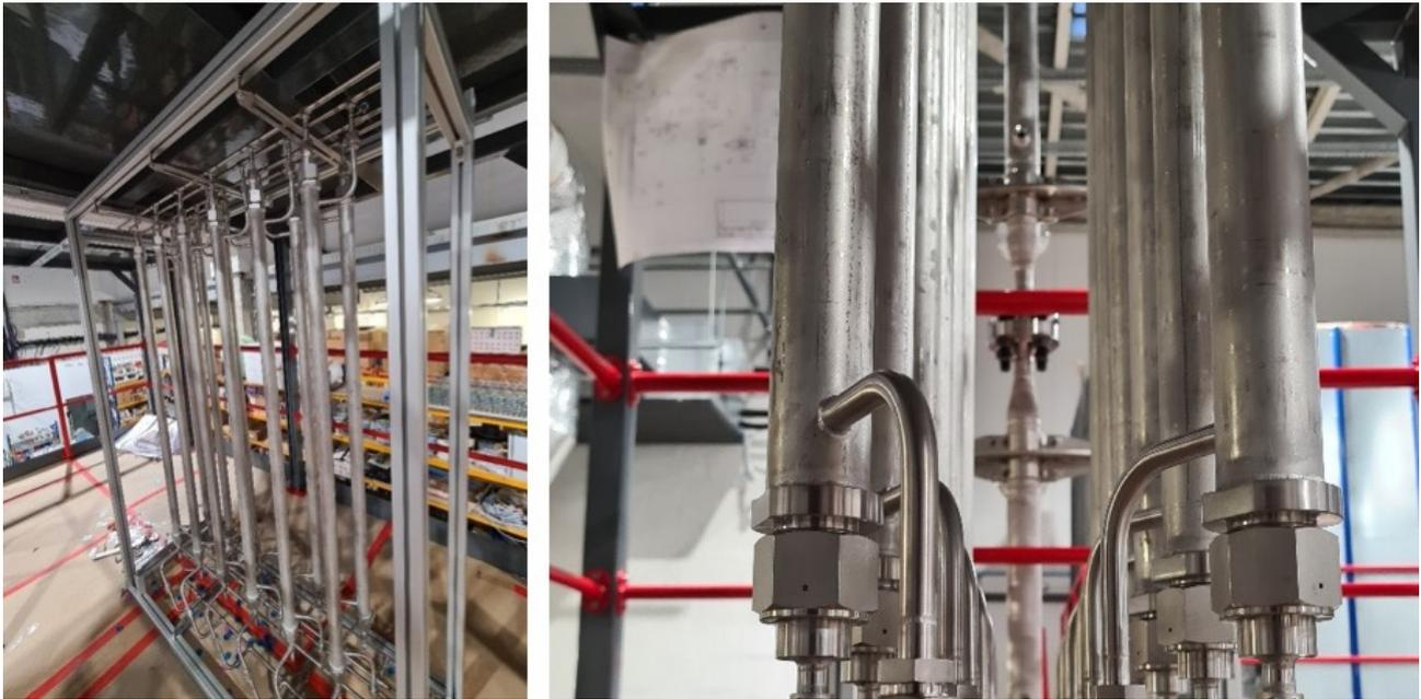
**Figura 3.10. Realizzazione della configurazione reattoristica multitubolare.**
