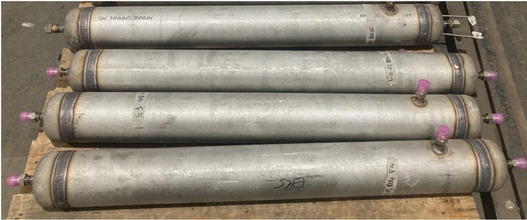
**Figura 3.7. Realizzazione dei separatori del fluido diatermico.**
