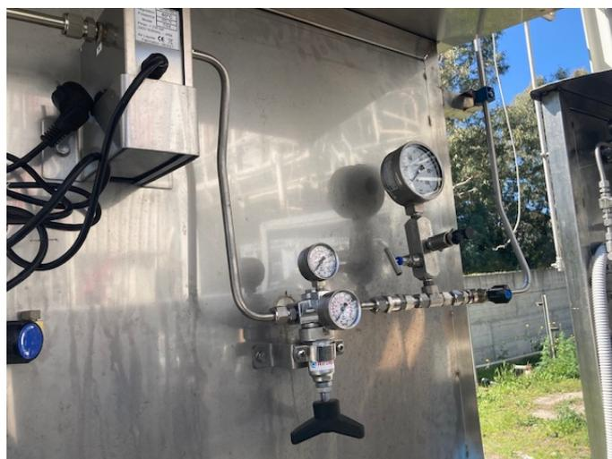
**Figura 4.11. Riduttore di pressione a valle del terzo riscaldatore.**
