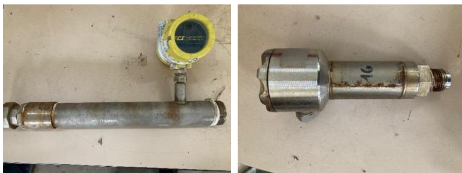
Figura 2.37. Misuratore di portata FT103 e di pressione PT298 dopo lo smontaggio.
